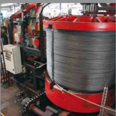
*La encarretadora automática vertical tipo SirioStar es el máximo sistema innovador utilizado para la producción de carretes compactos de hilo liso o de refuerzo con peso máximo 5 ton.*
